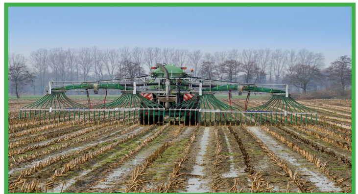
Technische Optimierung: Der Schleppschlauch verhindert Umweltbelastungen durch eine bodennahe Gülleausbringung www.umweltbundesamt.de
