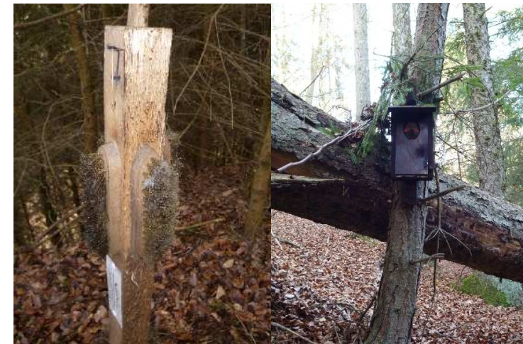
Abbildung 9: Lockstab mit Drahtbürste. Hier zu sehen mit Haarproben (links). Fotofalle verbergen in einem Nistkasten (rechts).
